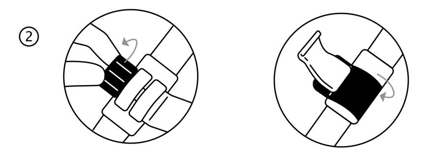
ROTATE THE SET SCREWTO THE DESIRED TIGHTNESS, AND CLOSETHE FLIP LOCK. MAKING SURE THE POLE DOESN'T SLIDE UNDER Pressure
